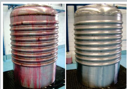
Todas as propriedades benéficas do aço inoxidável podem ser destruídas durante o processo de fabricação com tratamentos térmicos ou mecânicos como soldagem, corte, costura, furação ou dobramento. Como resultado destes processos, uma camada subjacente empobrecida em cromo se estabelece na superfície. A remoção mecânica dessa camada pode deixar material abrasivo ou outras partículas embutidas na superfície.
