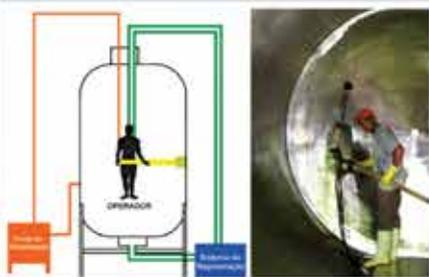
A Tecnologia EPL-H® também é chamada de seletiva ou localizada, pois processa-se através de um dispositivo que um homem movimenta na superfície da peça ou equipamento, sem a necessidade da mesma estar imersa em um banho.
