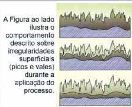
Além disso, remove metal da superfície de trabalho sem transformação mecânica ou térmica, eliminando as camadas danificadas mecanicamente, permitindo ainda que as propriedades originais do material sejam completamente restabelecidas.
