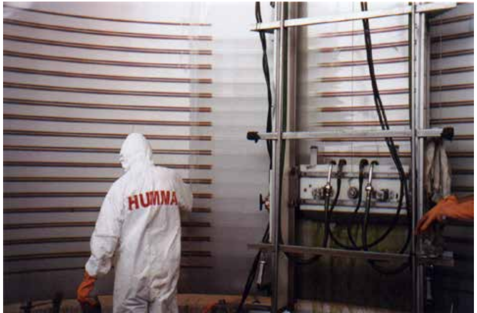
ELETRÓDECAPAGEM EM VIROLAS DE TANQUE DE FERMENTAÇÃO
